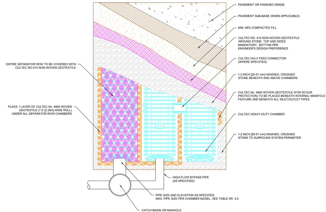
**TYPICAL SEPARATOR ROW CONFIGURATION PLAN VIEW**
